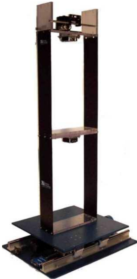
Obr. 1. Vibrační stůl s modelem dvoupatrové budovy a pohlcovačem umístěným ve druhém patře.
